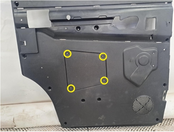
Irrota luukun kiinnitysruuvit. (ristipäämeisseli ph2).
