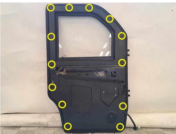
Irrota kiinnitysruuviin suojakorkit. (pieni talttameisseli).
