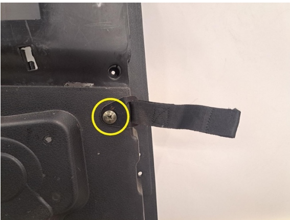
Irrota oven avauskulman rajoitinremmin kiinnitysruuvi, (ristipäämeisseli ph2) jolla on vastamutteri. (hylsy 10 mm).
