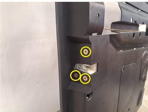
Irrota oven lukon kiinnitysruuvit. (ristipäämeisseli ph2).
